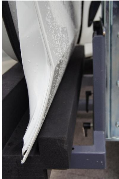
4. Die Tür mittels der oberen Türaufnahme entweder durch die rot gummierten V-Kimmen an den Seitenfalzen oder durch die mit schwarzem Hartschaum umhüllten Gegenhalter am Scheibenrahmen bzw. dem Scheibenausschnitt sichern.
